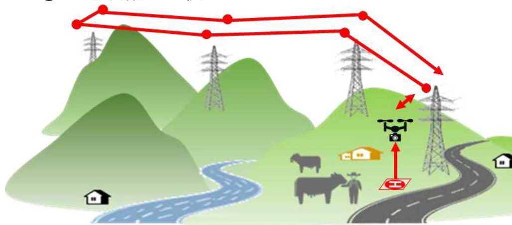
①送電設備の巡視
