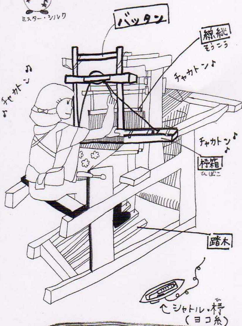
前回、その9で管巻きしたヨコ糸、「シャトル」を「バツタン」と言われる装置の左右に付いた<sup>(ムボコ)</sup>枠箱にセットし、線糸(その7)に繋がっている踏木を踏み込むとタテ糸が上下に分かれるので、その間を右手で取手を引っ張り、「シャトル」を左右に飛ばし、左手で「バツタン」を前後させてリズム良く、動かして織っていきます。途中、仮織りの糸を手で取り除きながら織っていくので「ほぐし織り」と言います。
