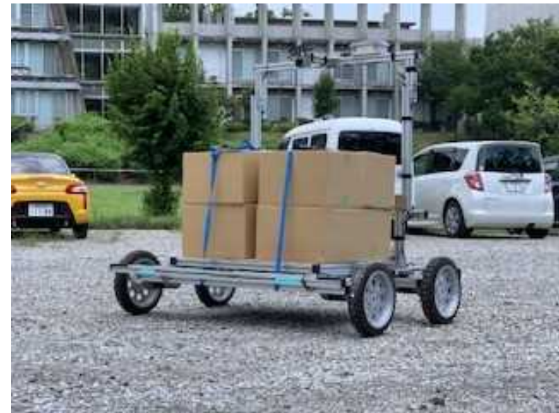
不整地（砂利敷き）での走行実験の様子
