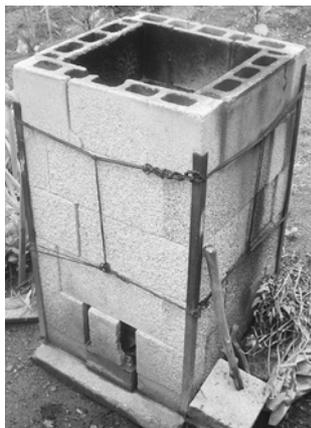
**対象** ブロック積簡易焼却炉、金属製簡易焼却炉
