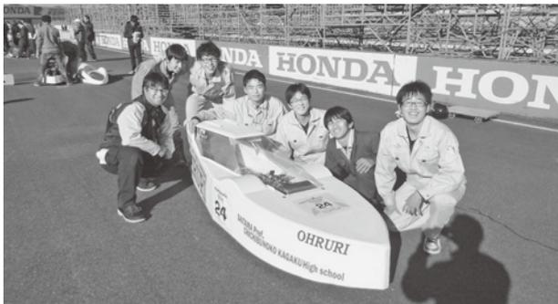
電気システム科が製作した電気自動車で、競技大会「Ene-1GP MOTEGI」に出場しました。学校で行ったテスト走行では、単三形充電電池40本を使用時に、時速20kmで1.5時間以上走行し、最高時速は50kmを記録しました。
